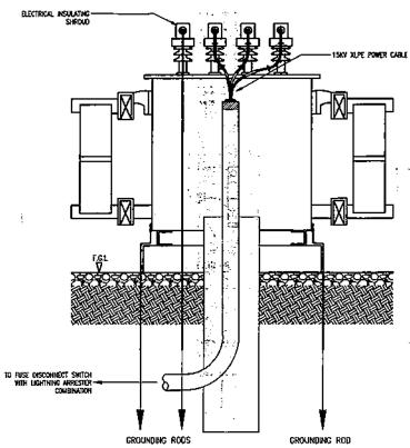
HIGH VOLTAGE CABLE TERMINATION CICSPV-80E-17.009 SCALE NTS
